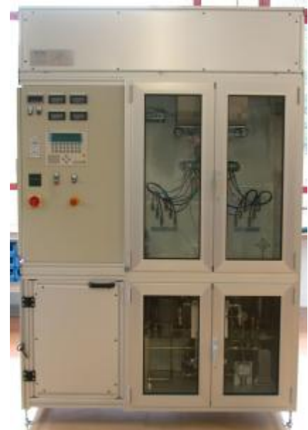
Prüfstand zur Erprobung von Axial-Kolbendichtungen
